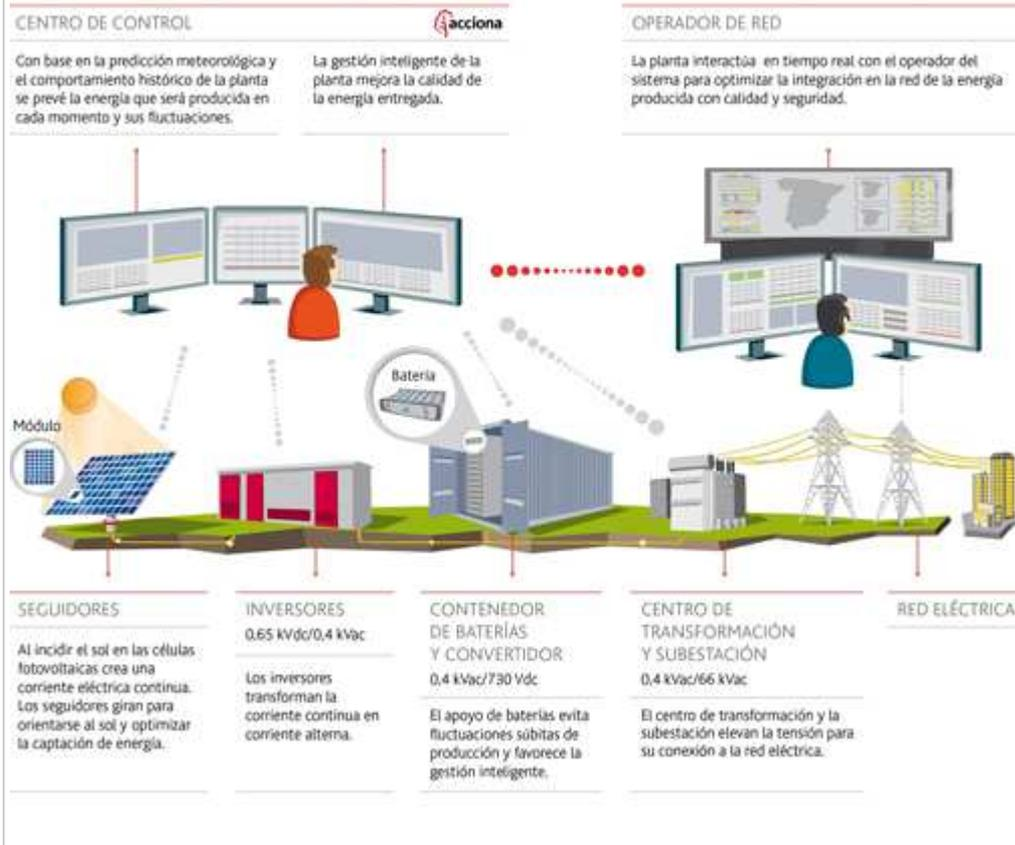
ACCIONA ha desarrollado estrategias para gestionar la planta fotovoltaica con almacenamiento del modo más eficiente, tanto en el uso de las baterías para modular la entrega de potencia por la planta, como en la prestación de servicios auxiliares a la red eléctrica.
